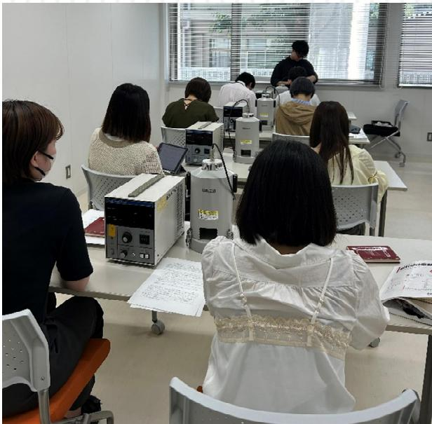
X線管から出る光子スペクトルの測定
